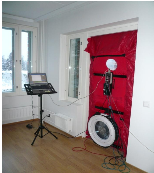
Kuva 6. Tiiviysmittauslaitteisto (kuva ei ole kohteesta).
