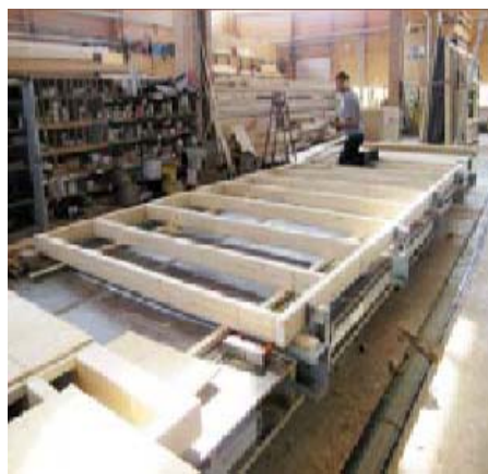
Kuva 34. TES Energy Facade-metodi perustuu vanhan rakennuksen tarkkaan mittaamiseen, 3D-mallin luomiseen, elementtien valmistukseen tehtaalla ja valmiiden elementtien asennukseen työmaalla. (lähde: http://www.tesenergyfacade.com/TES%20EnergyFacade.pdf )
